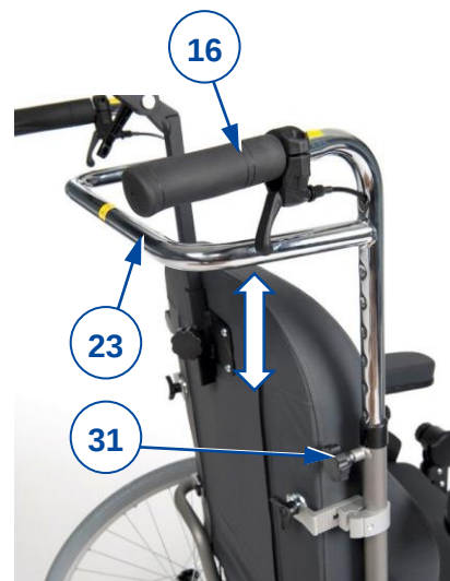
Obrázek 7 Nastavení výšky tlačného madla
